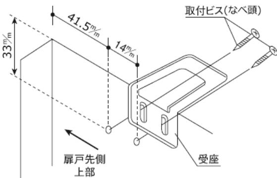
※取り付け寸法図の受座取り付け位置は、受座の長穴の中心を指しています。取り付けビスが長穴の中心になるように取り付けてください。
