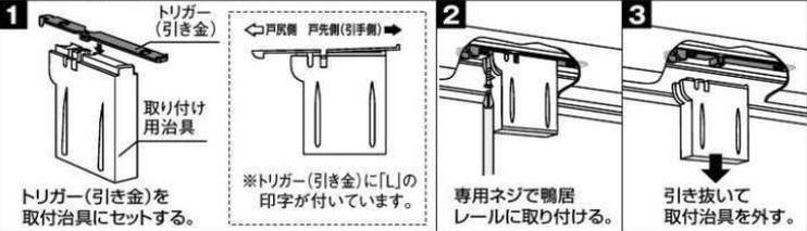
トリガー(引き金)を取付治具にセットする。
